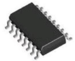
SOIC IC Chip
